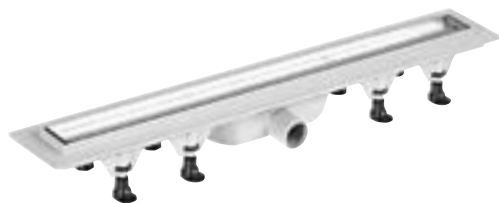
TILE műanyag padlóösszefolyó inox rosttal, burkolható magasság: 68 mm
